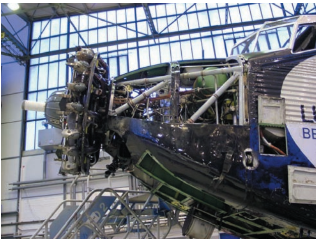
Freilegung des Mittelmotors für Kontrollen. Foto: Donth
