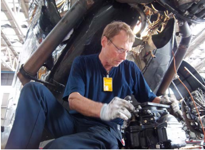
Hellmut Brandes wechselt einen Vergaser. (ps)
