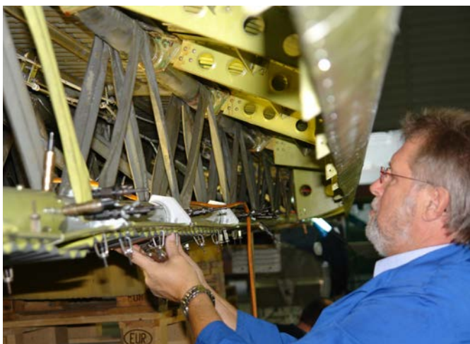
Reparatur der Tragfläche.
